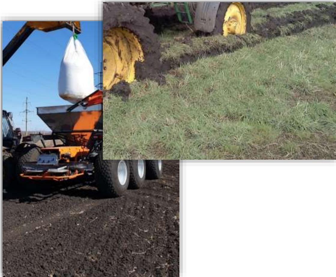
«Туман-2М» и «Туман-3» имеют два типа рабочих колес: узкие колеса и шины низкого давления.
