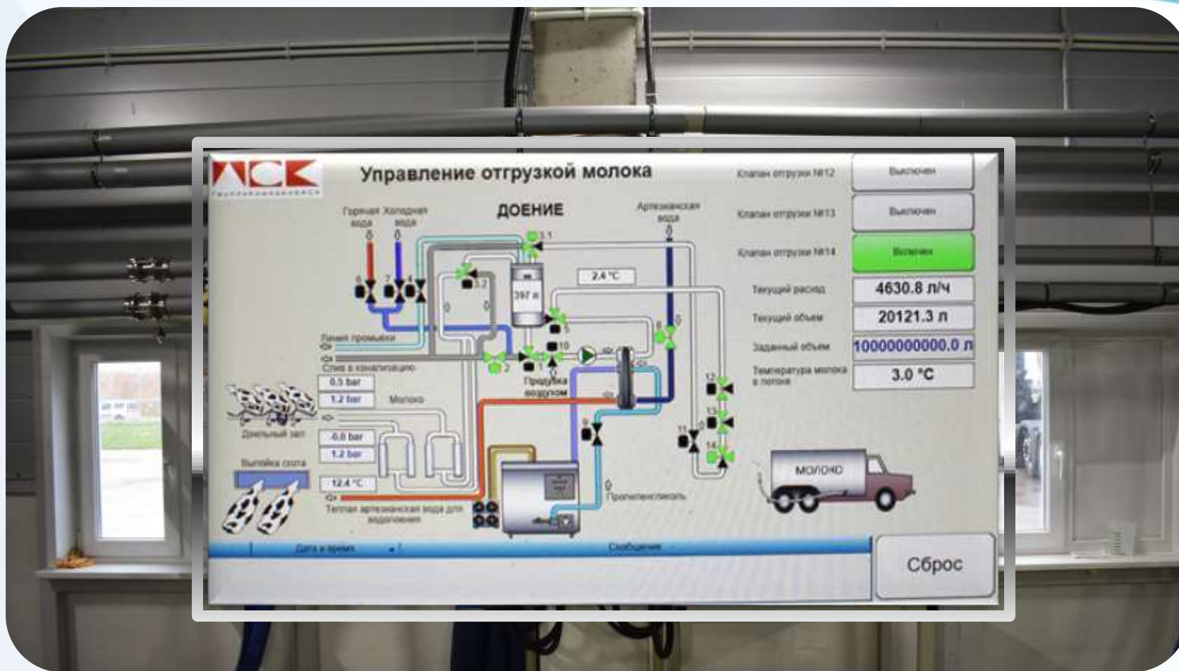
Автоматизация линии для отгрузки молока с передачей данных в программу с заданными параметрами
