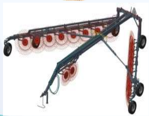
Грабли колесно-пальцевые серии МК
